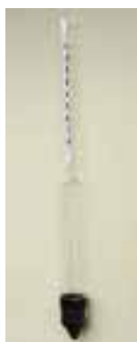
Foto 3.1. Izquierda: Hidrómetro graduado en porcentaje de materia seca. Derecha: análisis de purines con el Hidrómetro.
