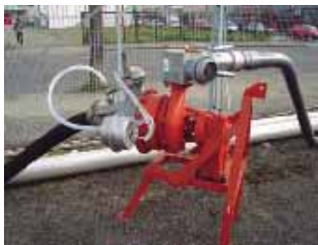
Foto 5.11. Bomba purinera para aspersión de purines en pradera.
