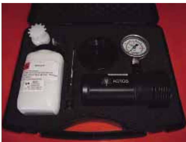
Foto 3.2. Agros, equipo para la determinación rápida del contenido de nitrógeno amoniacal. Agros Nova Meter incluyendo manómetro (1); Ajustador de pH - Hidróxido de Sodio (2); y Reactivo principal - Hipoclorito de Calcio (3).
