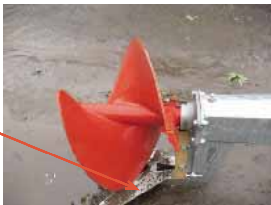
Foto 5.8. Mezclador de sinfín con picador incorporado.
