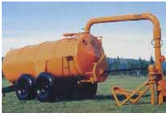
Foto 5.16. a) bomba de llenado estacionaria y b) carro con bomba accionada por cardán.
