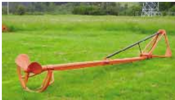
Foto 5.7. Agitadores de purín tipo hélice.
