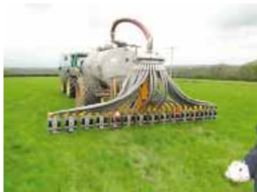
Foto 5.22. a) equipos de aplicación en banda con zapata y b) detalle de la zapata.
