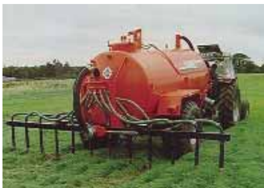
Foto 5.21. Equipo de aplicación en banda de purín.
