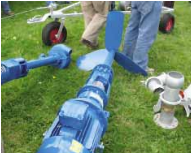
Foto 5.10. Bomba eléctrica montada sobre balsa flotante y revolvedor.
