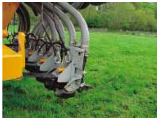
Foto 5.22. a) equipos de aplicación en banda con zapata y b) detalle de la zapata.
