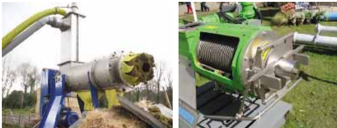
Foto 5.26. Diferentes separadores de purines tipo sinfín.
