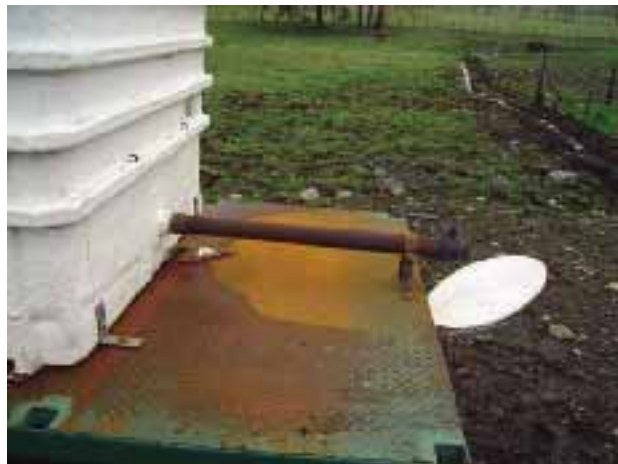
Foto 5.17. Carro simple con vaciado gravitacional.
